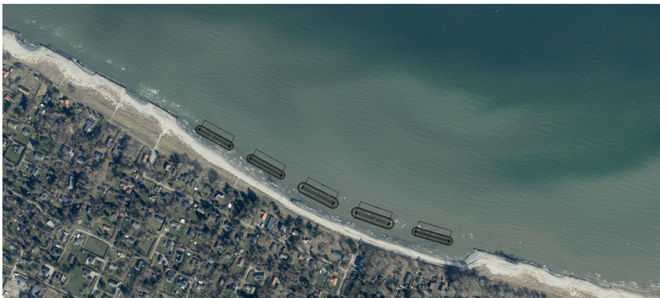
Figur 40 Ideoplæg til placering af nye bølgebrydere. De 2 mest vestlig placerede bølgebrydere samt den østligste er placeret på 1m vanddybde. De resterende 2 er placeret på 2m vanddybde.
