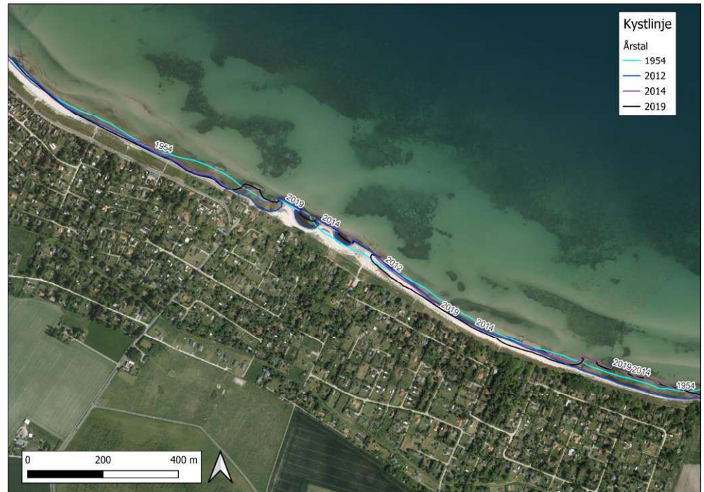
Figur 1 Kystlinje-udvikling fra 1954 og frem til 2024 som er det bagvedliggende flyfoto. Der kan ikke påvises øget læside-erosion vest for sidste bølgebryder i perioden 2012-2024. Kilde: Klimadatastyrelsen 2024
