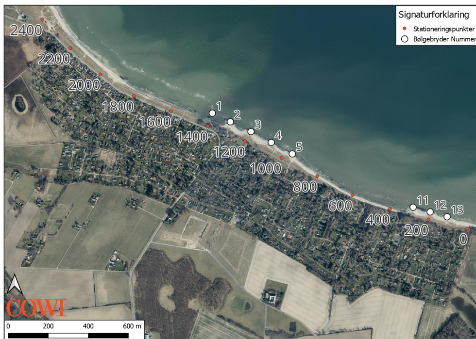
Figur 4-4 Stationeringsnumre per 200 m samt markering af bølgebrydernummer
